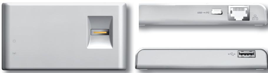
EduKey mit Fingerabdruck-Scanner sowie mit USB- und Ethernetanschlüssen
