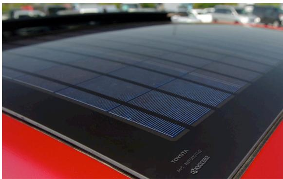
**Bild 5** Solardach eines Toyota-Prius (Quelle: Kyocera Fineceramics GmbH) [4].
