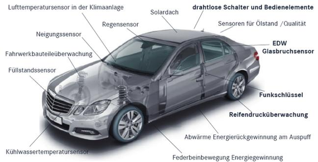
**Bild 2** Überblick potentieller energieautarker Sensorik im Automobil (Quelle: Daimler AG) [4].
