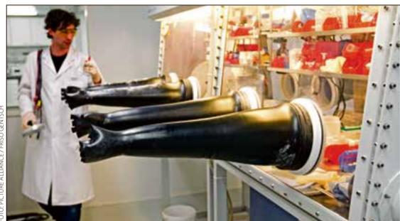
**Batterieforschungszentrum in Münster:** Energiezellen werden unter Ausschluss von Sauerstoff und Feuchtigkeit getestet
