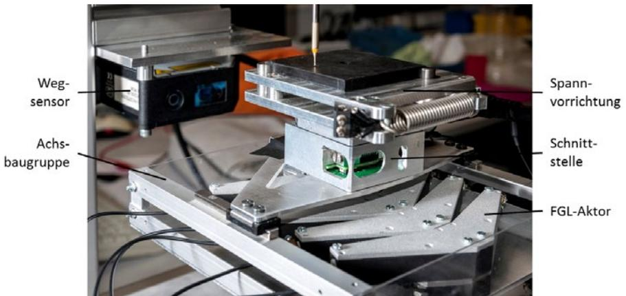
Das Teilprojekt des Lehrstuhls für Produktionssysteme (LPS) im Rahmen des SPP 1476 „Kleine Werkzeugmaschinen für kleine Werkstücke“ befasst sich mit der Entwicklung einer modularen Antriebsachse bestehend aus mehreren Aktormodulen.
