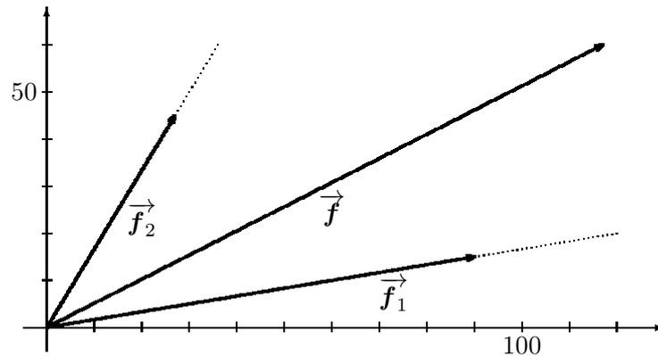
Kräfte die an einem Punkt angreifen, verhalten sich wie Vektoren. Sie können also addiert und insbesondere in Komponenten mit vorgegebenen Richtungen zerlegt werden. Z.B. soll eine Kraft  $\vec{f}$  in zwei Kräfte  $\vec{f}_1, \vec{f}_2$  mit den vorgegeben Richtungen  $\mathbf{r}_1$  bzw.  $\mathbf{r}_2$  zerlegt werden. Gegeben seien
