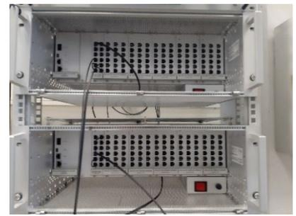
ABBILDUNG 7: STEUERBOXEN ZUR ANSTEUERUNG DES IGBT-SCHALTERS.
