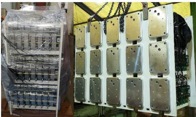
ABBILDUNG 6: IGBT-SCHALTER.
