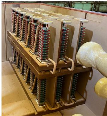
ABBILDUNG 5: B6-DIODENBRÜCKE IN DER TANKEINHEIT.
