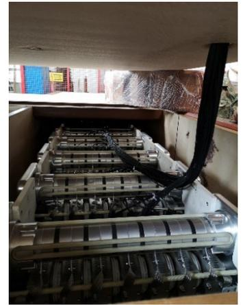
ABBILDUNG 3: IGBT IN TANK MIT LWL.
